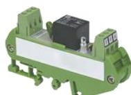
Permet de commander des verrous, ventouses en gardant une isolation galvanique entre l'électronique de l'ABIOLock RELAIS et le système de verrouillage choisi.
